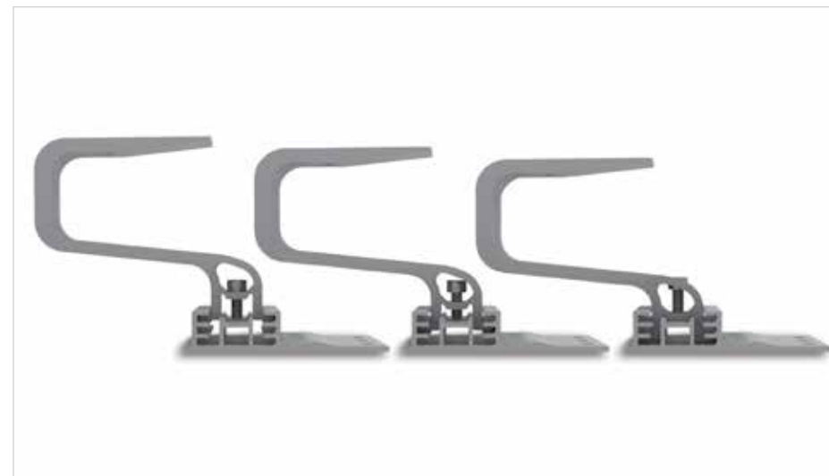
Detail Abbildung - Höhenverstellbarkeit CrossHook 3S Höhenstufungen (40/47/54 mm)
